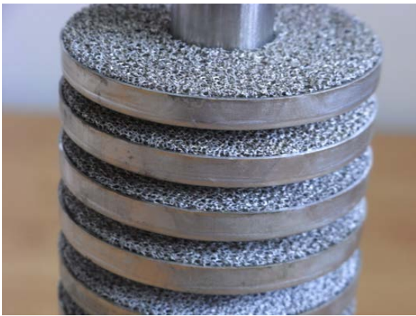
Figuur 7: Foto van een reactorelement, stalen buis, aluminium vin en schuim
