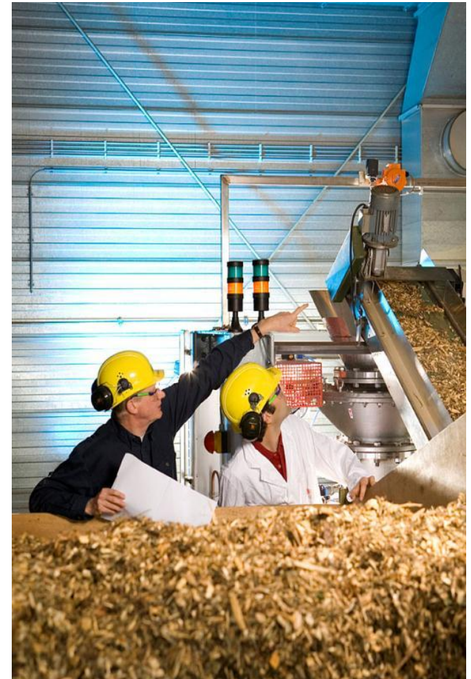
ECN 50 kg/h torrefaction pilot-plant
