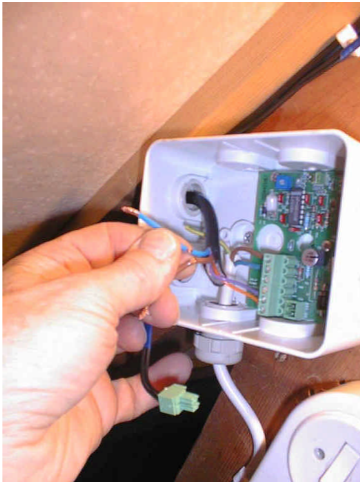
Aansluiting van de computerkabel in de zonnestroomindicator
