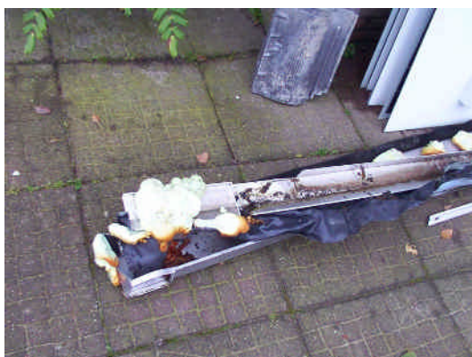
Vervanging van het frame van geïntegreerde PV-panelen waarop dakpannen met PUR-schuim bevestigd waren. Het PV-systeem is later op beugels gemonteerd
